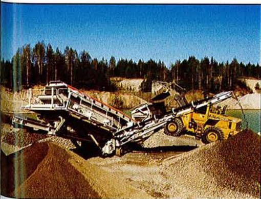
Lokotrack primário trabalhando em reciclagem
