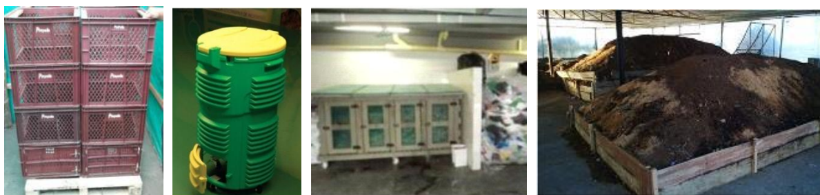
Figura 1 – Composteiras individuais e coletivas com aeração convectiva e pilha estática sob galpão, com aeração forçada e convectiva (ACODAL, Colômbia).
