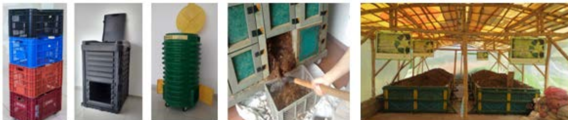
Figura 4 – Composteiras individuais e coletivas com aeração natural e pilha estática sob galpão, com aeração forçada e natural (ACODAL, Colômbia).
